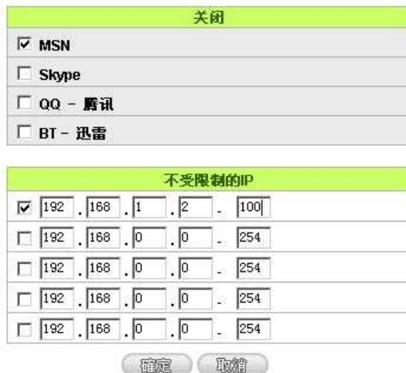
图三：本图可以看出内部网络 192.168.1.2~100 的 IP 将不提供 MSN 及时信息服务功能，中小企业可以按照需要对内网 IP 的这几个特定服务做挡定设置。
