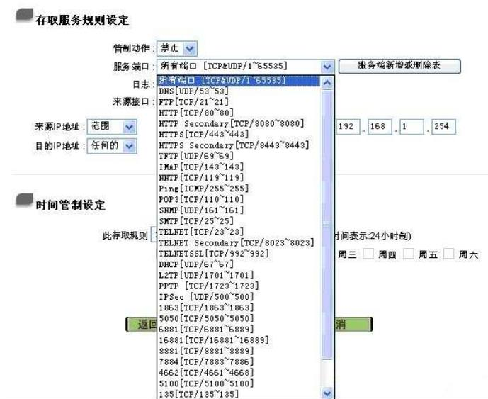
图七：应用的管制是利用网络应用的端口数，加以进行管制。
