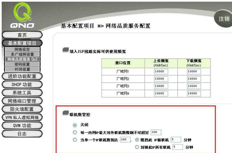
图四：联机数管控是另一种有效限制大量占用带宽软件的一种方法，联机数管控可配置特定时间管控，也可设定不受限制的服务（公司财务数据的传输，邮件的传输等）或者 IP 不受联机管制。
